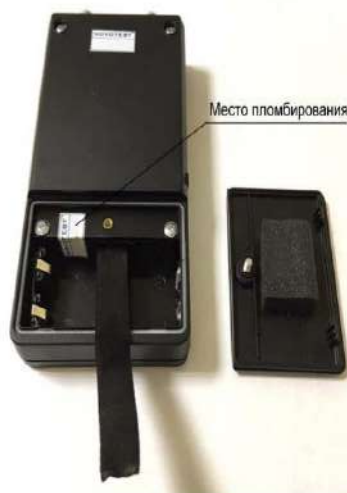
Рисунок 3 - Место пломбирования корпуса прочности строительных материалов NOVOTEST ИПСМ
