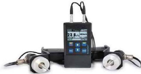
Рисунок 1 - Общий вид измерителей прочности строительных материалов NOVOTEST ИПСМ
