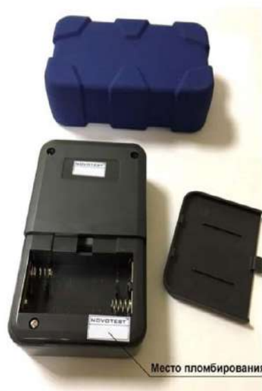
Рисунок 4 - Место пломбирования корпуса измерителей прочности строительных материалов NOVOTEST ИПСМ-М
